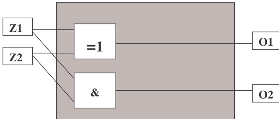
Die Logikschaltung *HALBADDIERER* kann als Logikbaustein implementiert werden. Die Logikschaltung benötigt zwei Eingänge *Z1* (=I1) und *Z2* (=I2).
